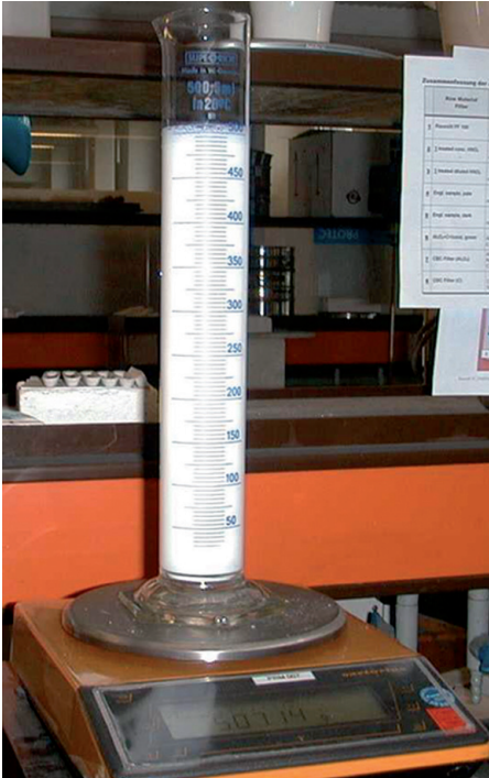
Abbildung 13: Dichtemessung mit Hilfe von Gewicht und Volumen
